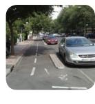
Vía ciclista que discurre adosada a la calzada, señalizada al efecto, en un solo sentido o en doble sentido. Se consideran protegidos cuando están separados del resto de la calzada mediante bordillos o bolardos. La modalidad de carril-bus-bici establece la circulación combinada de los autobuses y las bicicletas.
